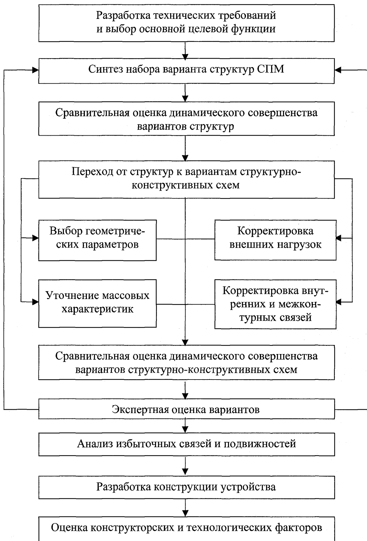
Рис.3.10. Методика композиции свободнопоршневых энергоустановок на этапе предэскизного проектирования
