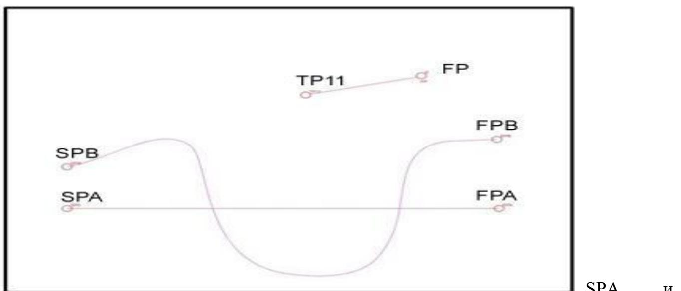
SPA и FPA определяют начало и конец прямой линии, SPB и FPB определяют начало и конец кривой. Полет начинается в SPA и следует в направлении FPA.
