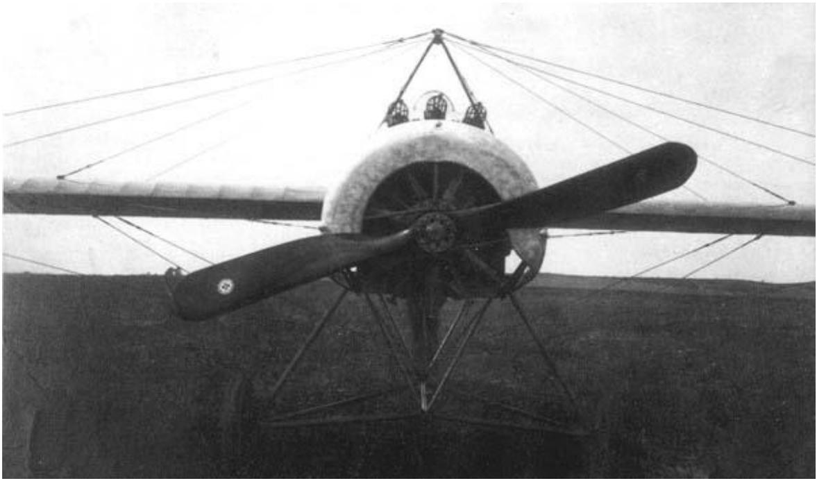
Вот что пишет журнал Flight (февраль 1913): “ Их форма необычна и, является результатом нескольких лет научных исследований. Гибкость конструкции их лопасти препятствует деформации пропеллера и позволяет ему адаптироваться к изменениям скорости машины не приводя к вибрациям, независимо от типа машины или мощности двигателя он всегда будет давать наибольший эффект”.
