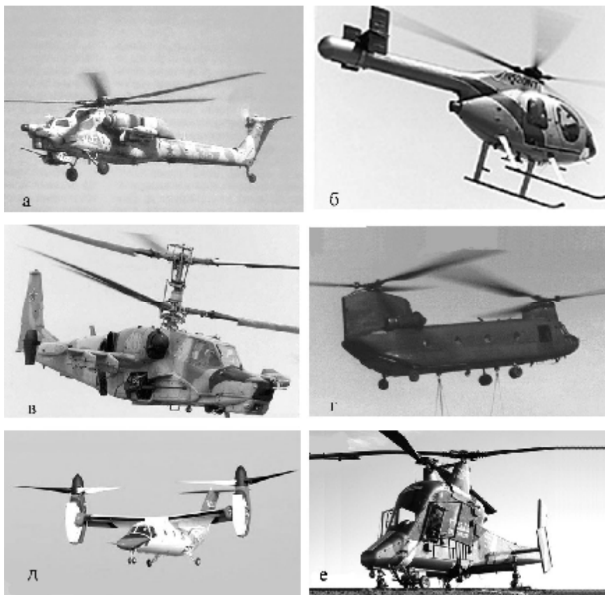
Рисунок 1. Различные схемы расположения несущих винтов.
