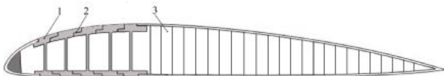
Рисунок 16. Сечение многолонжеронной лопасти несущего винта.
