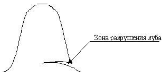
Рисунок 66. Возникновение трещины в корне зуба.
