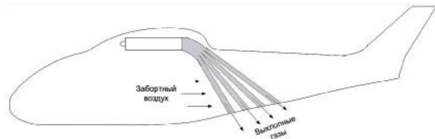
Рисунок 105. Эффективная схема охлаждения выхлопных газов.
