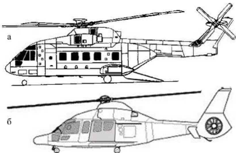
Рисунок 38. Вертолет с открытым грузовым трапом (а) и со сдвижной боковой дверью транспортного отсека(б).
