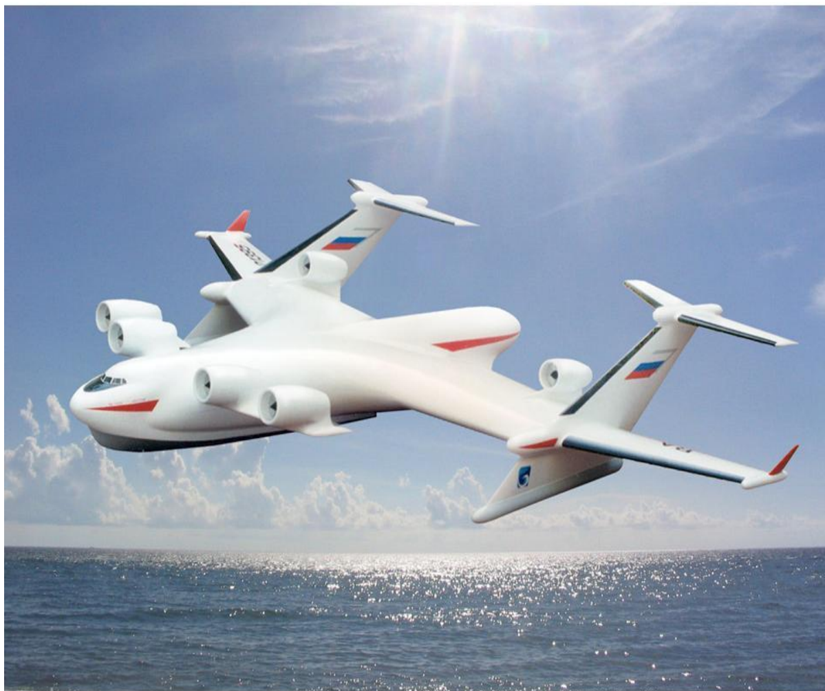
Фиг. 24. Экранолёт Бе-2500 с наплывами у борта лодки.
