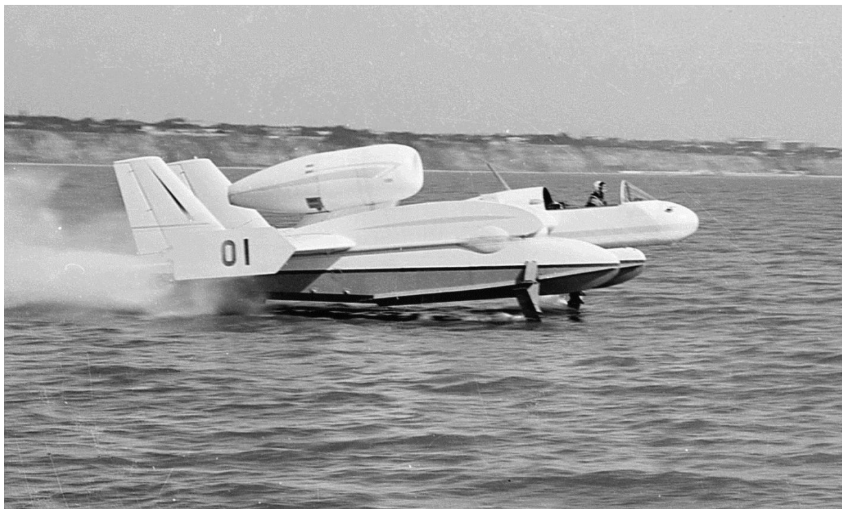
Гидролёт Бе-1 на режиме глиссирования ( V=180\text{км/ч} ).
