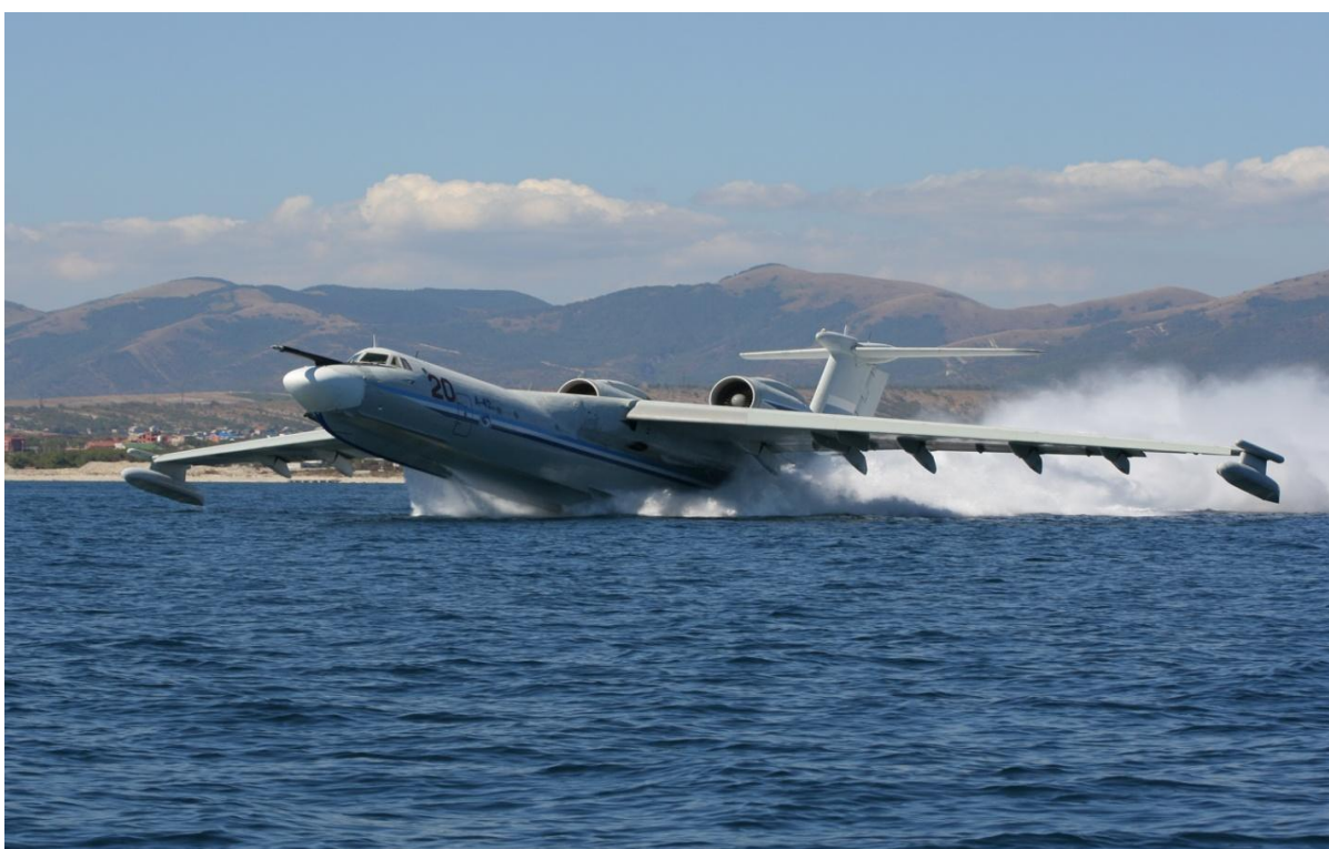
Самолёт – амфибия А-40 - выход на режим глиссирования.
