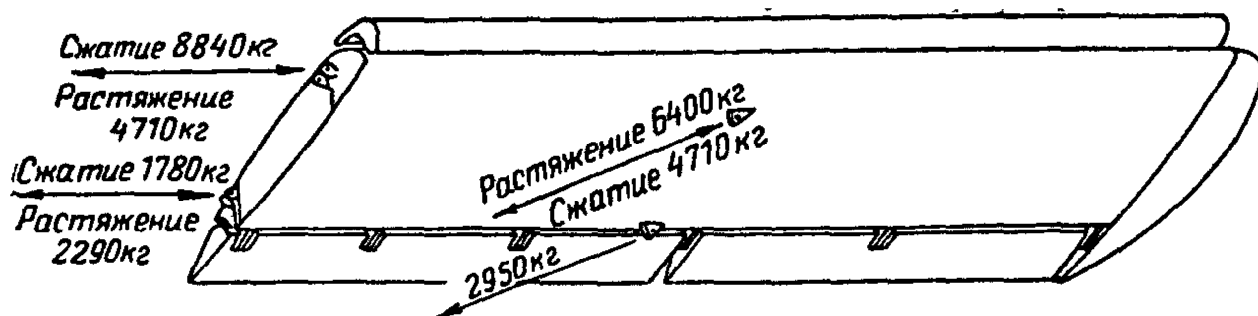
Фиг 46 Схема расчетных нагрузок на стыковые узлы крыла с подкосами самолета Як-12М
