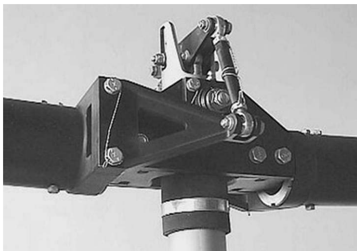
Рис. 2.4.6. Ротор вертолета Helisport CH-7 Angel
