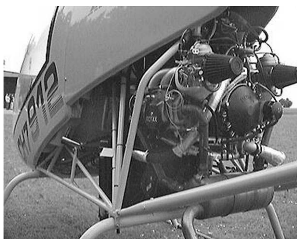
Рис. 2.4.5. Силовая установка вертолета Helisport CH-7 Angel
