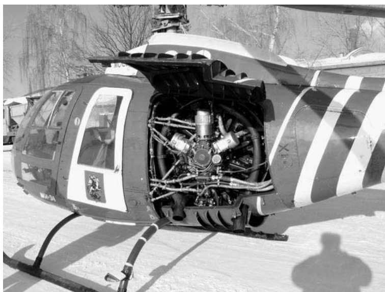
Рис. 2.11.3. Роторно-поршневой двигатель РПД-430ВАЗ
