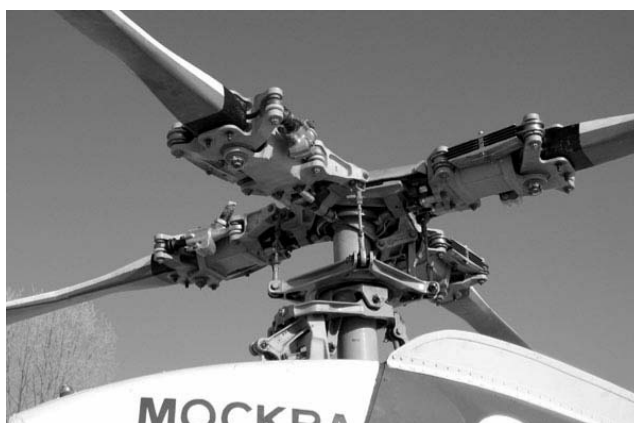
Рис. 2.8.6. Несущий винт вертолета
