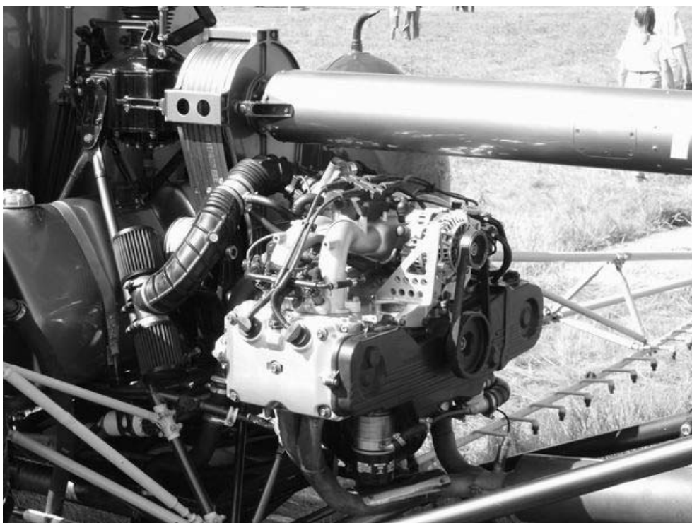
Рис. 2.43.11. Двигатель EJ-25, ременная передача, главный редуктор
