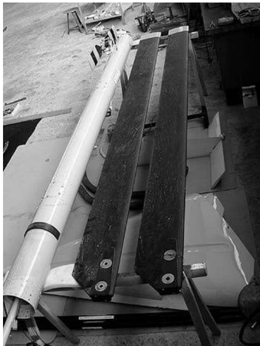
Рис. 2.3.3. Лопасти несущего винта
