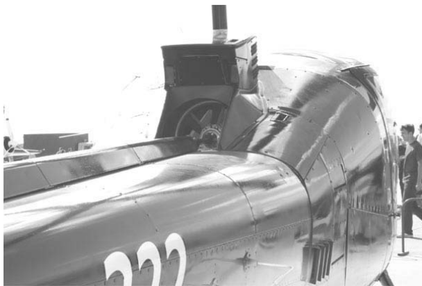
Рис. 2.42.18. Трансмиссия хвостового винта
