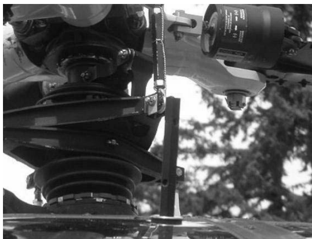
Рис. 2.22.6. Автомат перекося несущего винта
