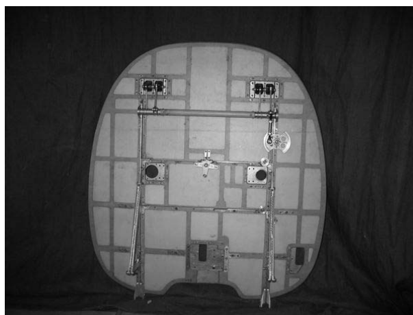
Рис. 2.43.5. Ферма и стенка кабины вертолета АК 1-3
