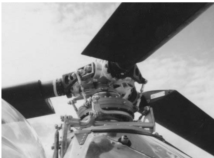
Рис. 2.31.6. Несущий винт, втулка и автомат перекоса несущего винта
