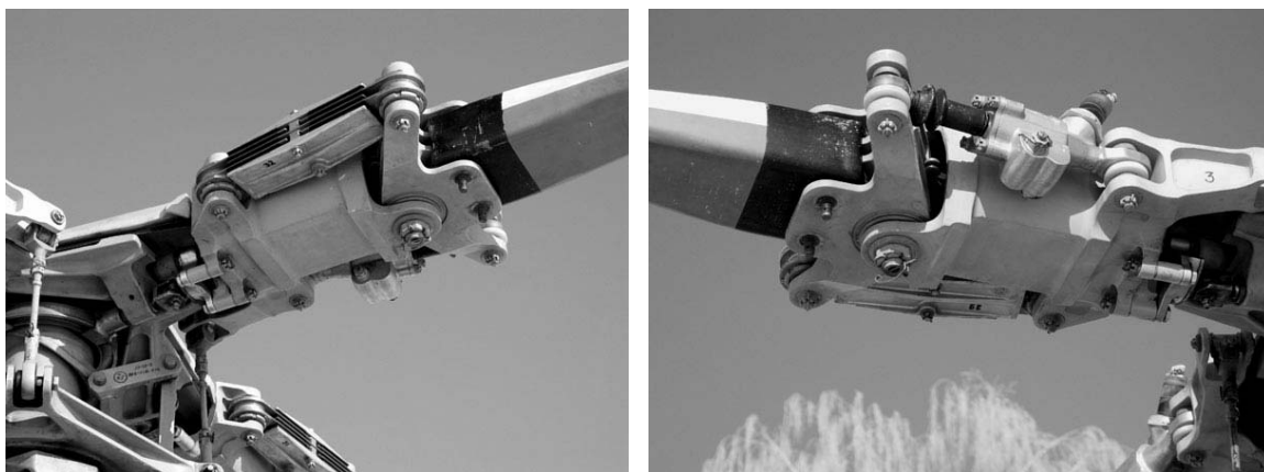
Рис. 2.8.7. Автомат перекоса несущего винта
