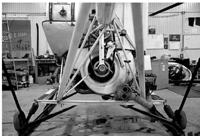
Рис. 2.19.11. Двигатель Лайкоминг 0-360-C2D
