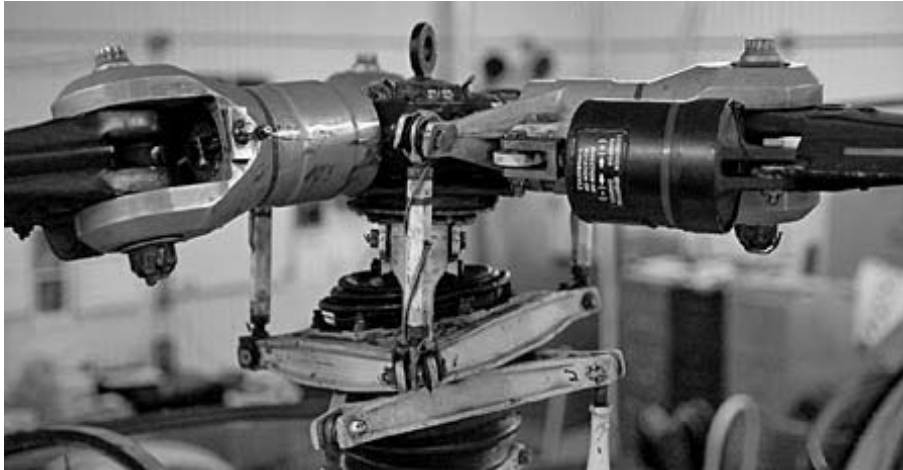
Рис. 2.19.12. Несущий винт и автомат перекоса
