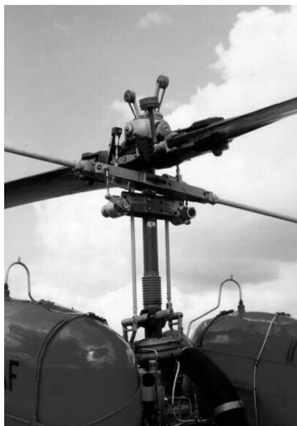
Рис. 2.46.24. Трансмиссия и несущий винт вертолета Bell 47G-3B-2 «Sioux»
