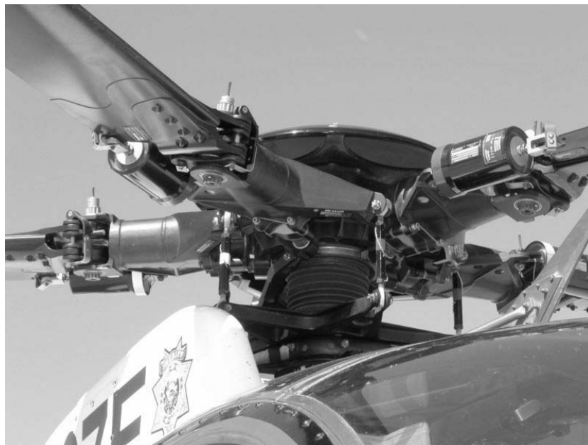
Рис. 2.37.9. Несущий винт и автомат перекоса
