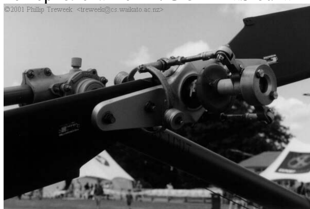
Рис. 2.46.28. Хвостовой винт вертолета Bell 47G-3B-2 «Sioux»
