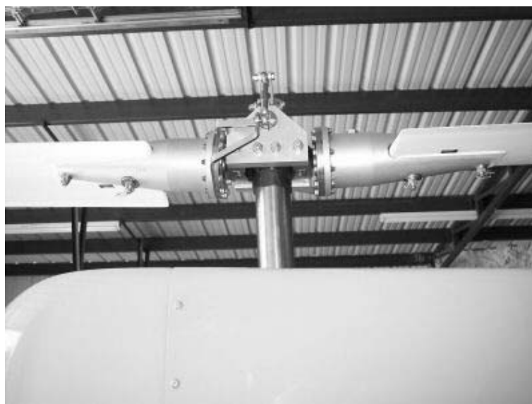
Рис. 2.38.6. Несущий винт
