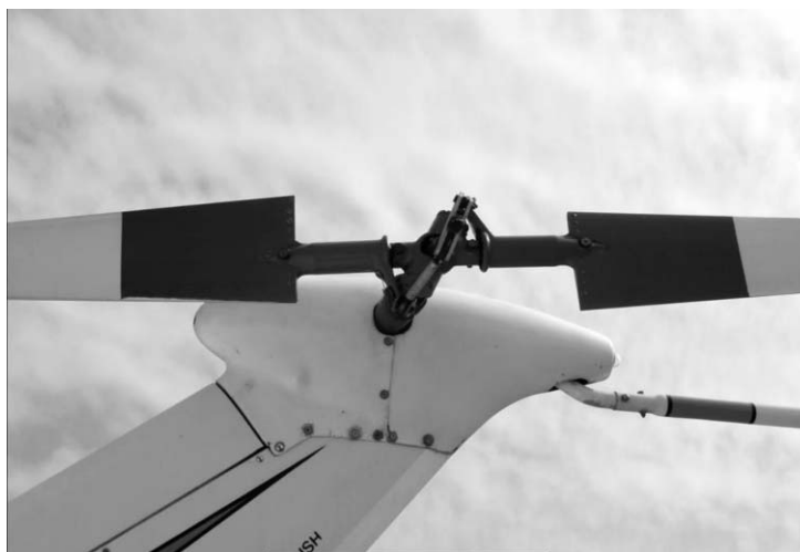
Рис. 2.26.5. Рулевой винт
