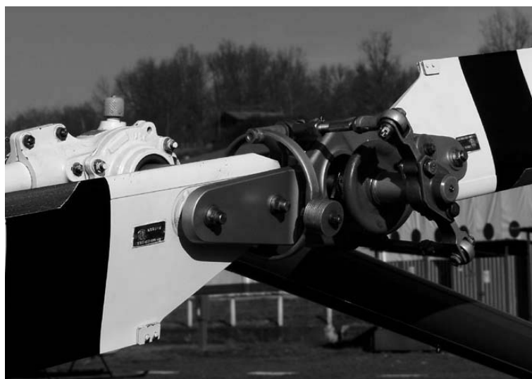
Рис. 2.46.43. Хвостовой винт вертолета Bell 47J-3
