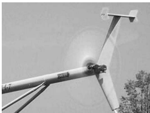
Рис. 2.5.7. Хвостовой винт вертолета
