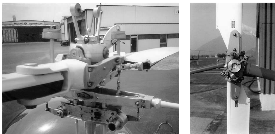
Рис. 2.46.34. Автомат перекося и хвостовой винт вертолета Bell 47G-4
