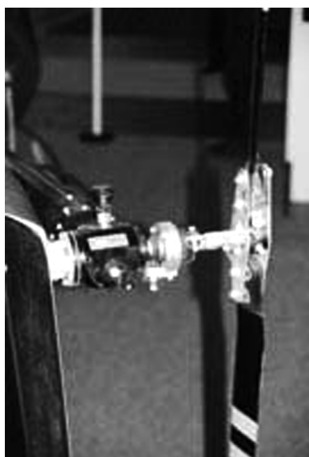
Рис. 2.2.9. Рулевой винт
