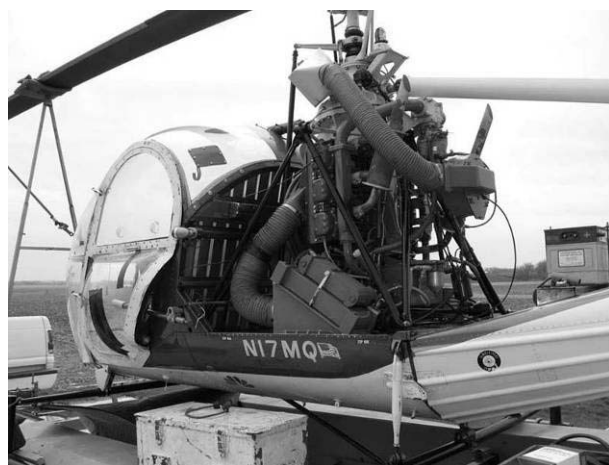
Рис. 2.27.13. Силовая установка вертолета
