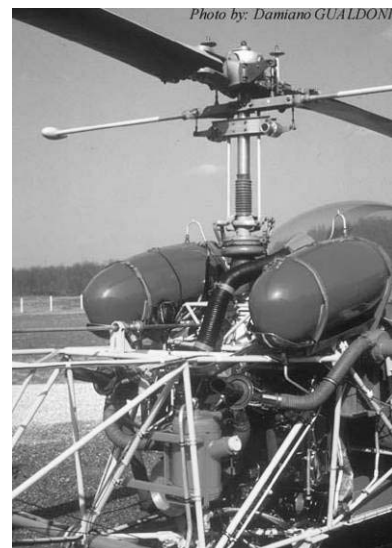
Рис. 2.46.12. Силовая установка и несущий винт вертолета Bell 47G-2
