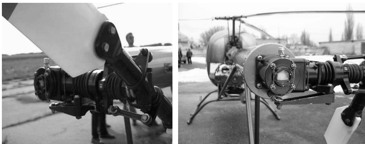
Рис. 2.43.20. Рулевой винт
