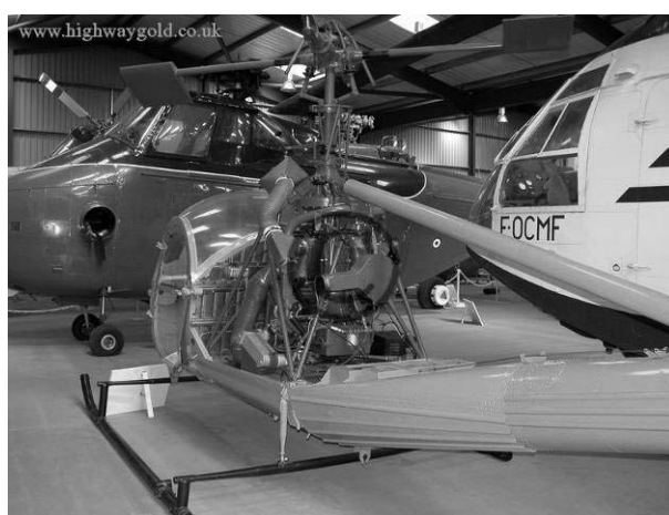
Рис. 2.27.13. Силовая установка вертолета
