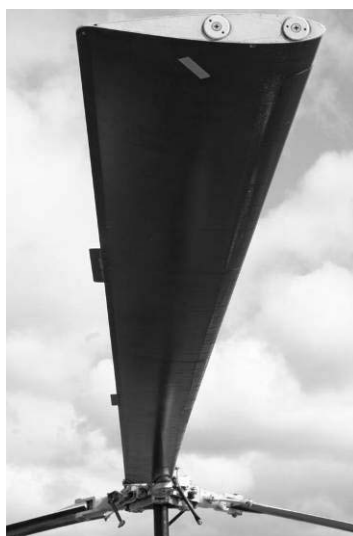
Рис. 2.42.17. Лопасть несущего винта
