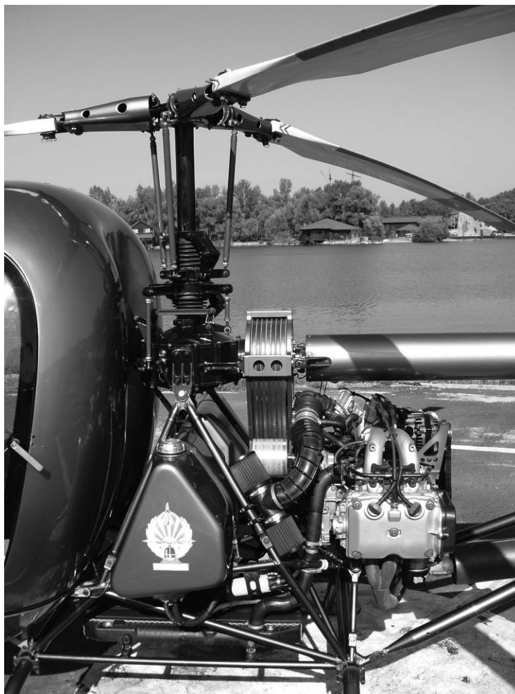
Рис. 2.43.13. Силовая рама фюзеляжа вертолета в сборе с кабиной экипажа, шасси, несущей системой, хвостовой балкой и подкосами хвостовой балки
