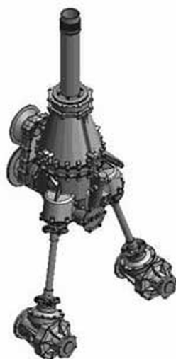
Рис. 2.13.13. Трансмиссия вертолета
