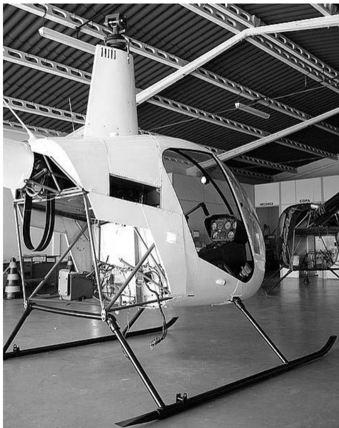
Рис. 2.17.5. Конструкция фюзеляжа
