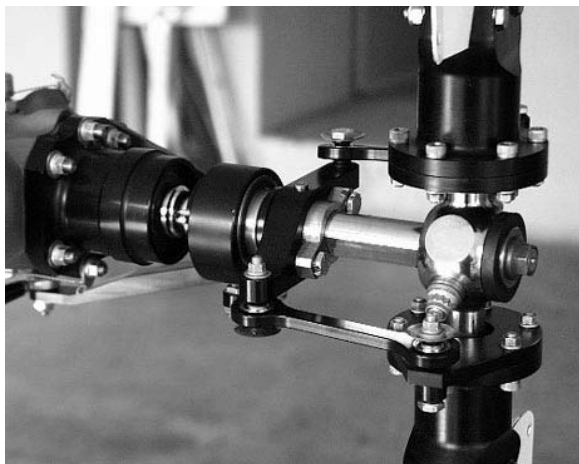
Рис. 2.5.8. Хвостовой винт вертолета
