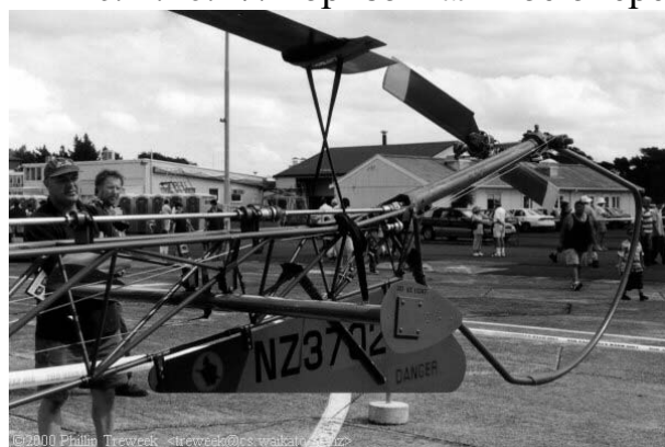
Рис. 2.46.28. Хвостовой винт вертолета Bell 47G-3B-2 «Sioux»
