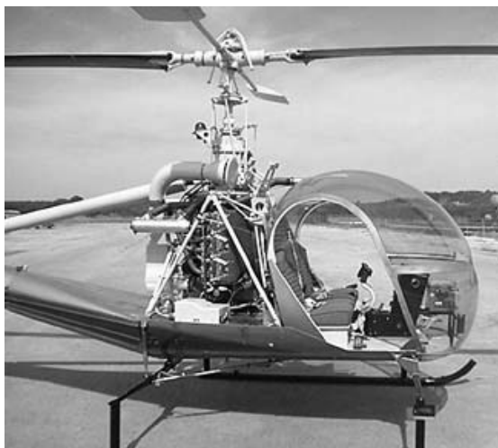
Рис. 2.27.12. Несущий винт и автомат перекося вертолета
