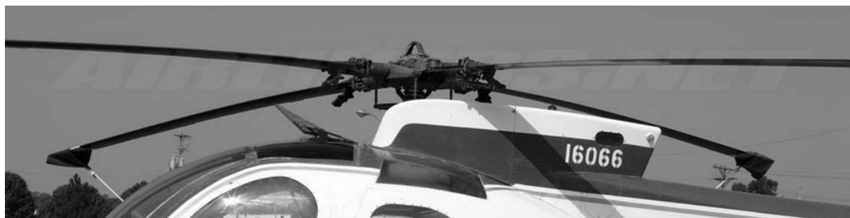
Рис. 2.25.9. Несущий винт
