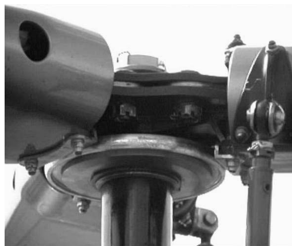
Рис. 2.43.14. Автомат перекоса с тягами управления
