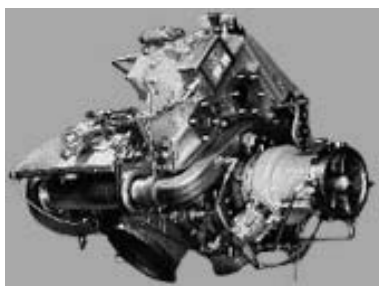
Рис. 2.42.5. Двигатель Rolls Royce 250-C20W
