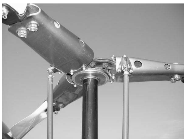
Рис. 2.43.14. Автомат перекоса с тягами управления
