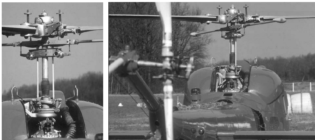
Рис. 2.46.41. Несущий винт и главный редуктор вертолета Bell 47J-3
