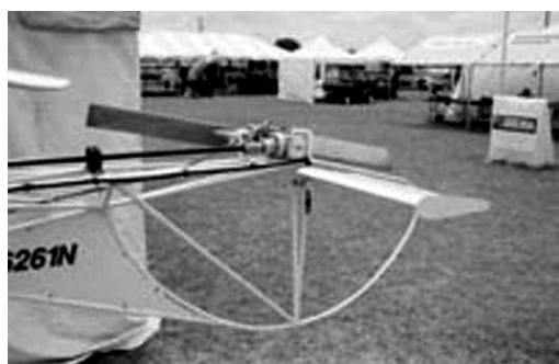
Рис. 2.6.8. Узел рулевого винта
