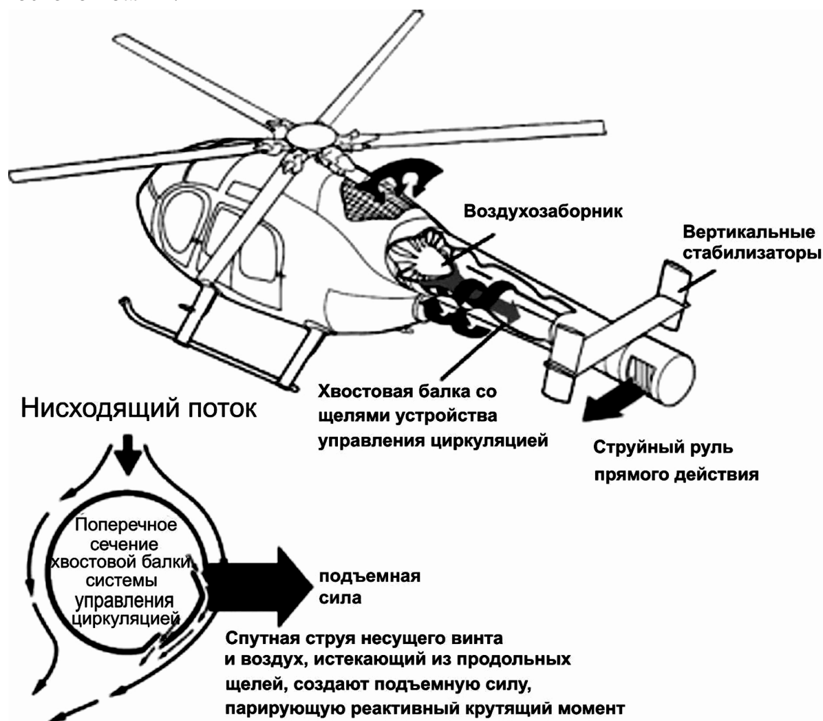
Рис. 2.37.13. Принцип действия системы NOTAR
