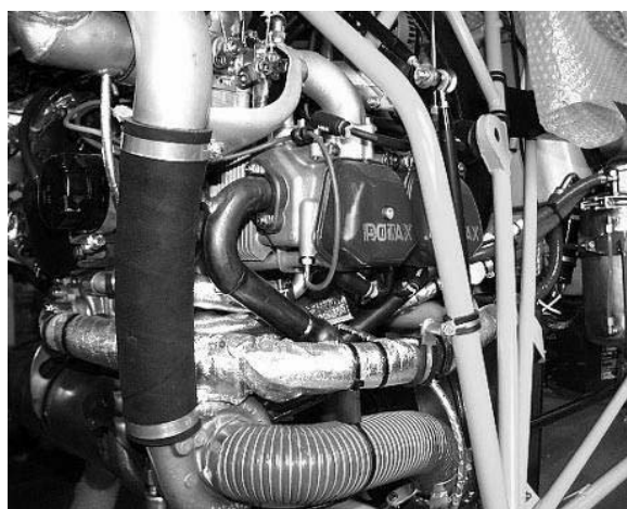
Рис. 2.5.9. Двигатель Rotax 914 Turbo
