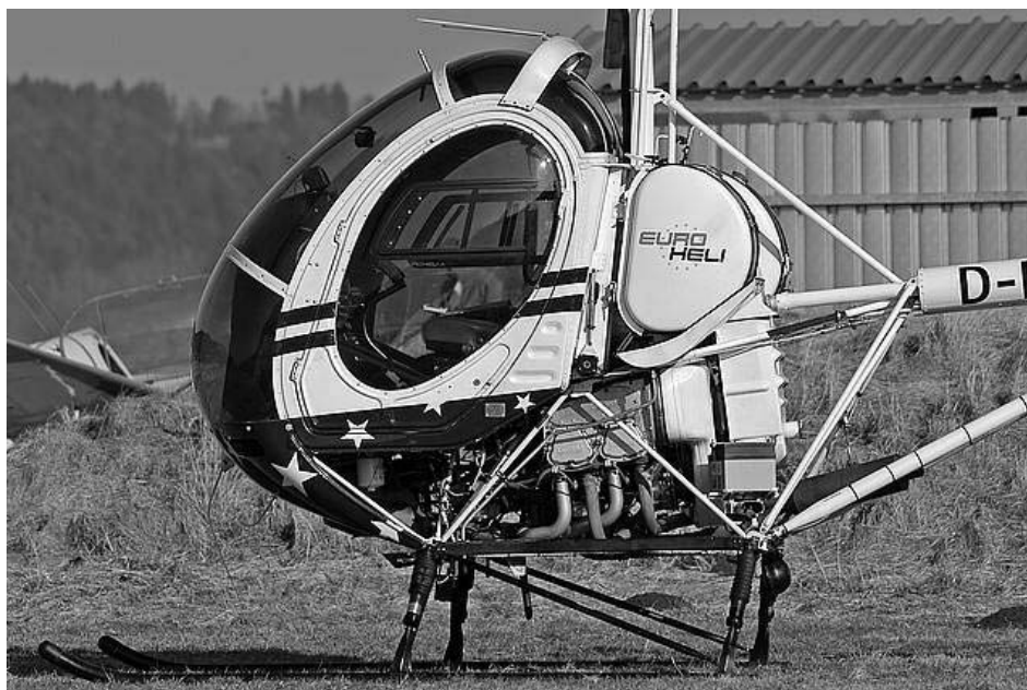
Рис. 2.21.3. Конструкция фюзеляжа и силовая установка
