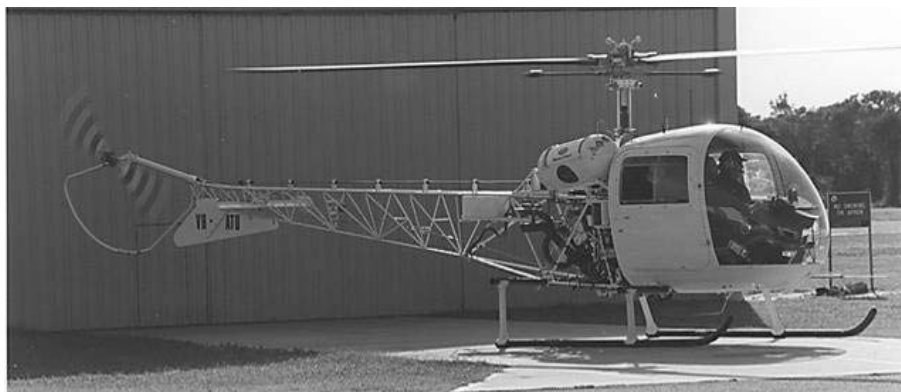
Рис. 2.46.49. Вертолет Kawasaki KH-4 с ползковым шасси
