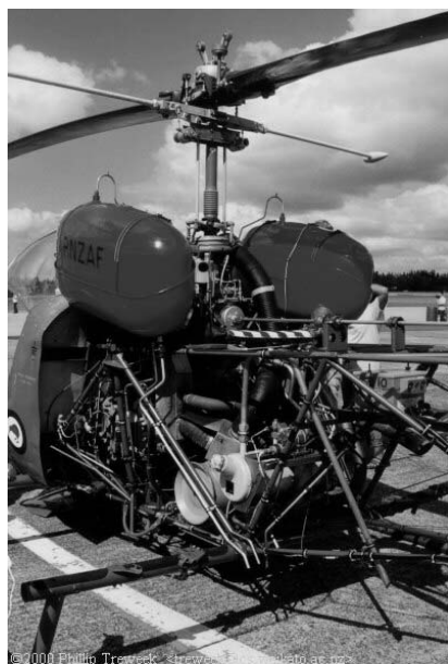
Рис. 2.46.24. Трансмиссия и несущий винт вертолета Bell 47G-3B-2 «Sioux»
