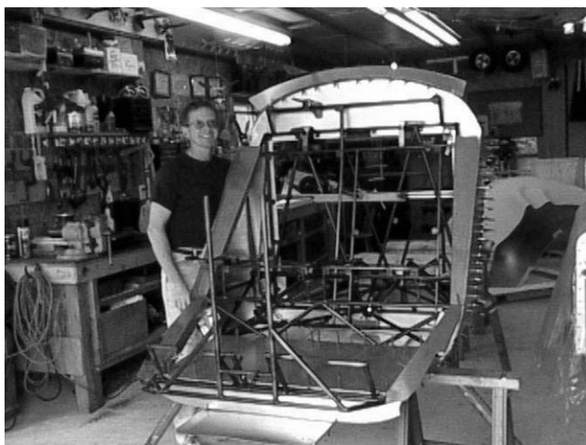
Рис. 2.6.9. Ферма фюзеляжа
