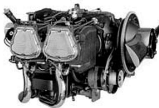
Рис. 2.21.4. Двигатель Lycoming серии 360
