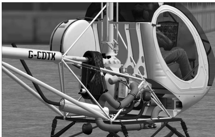
Рис. 2.22.4. Компоновка двигателя и трансмиссии На двигателе НЮ-360-D1А вместо сервопоса установлен карбюратор.
