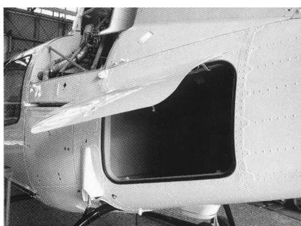
Рис. 2.7.4. Силовая установка и багажный отсек вертолета PZL Sw-4
