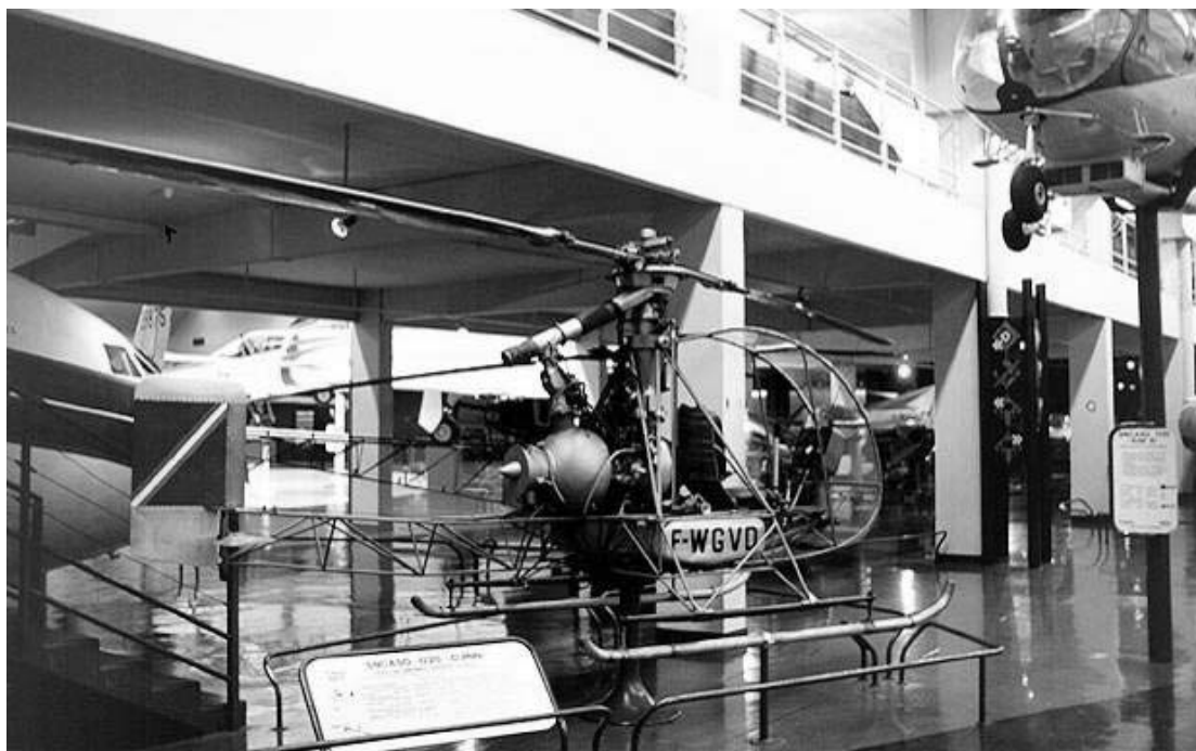
Рис. 2.45.7. Несущий винт вертолета
