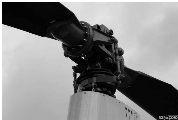
Рис. 2.18.8. Втулка несущего винта и автомат перекоса
