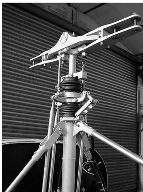
Рис. 2.3.6. Втулка несущего винта
