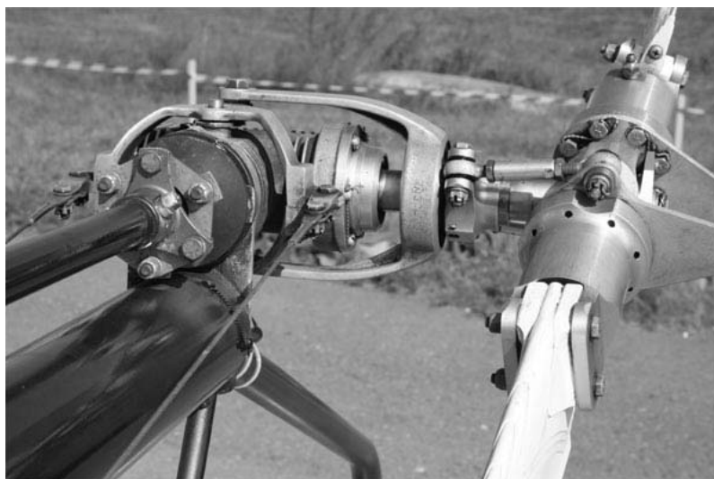
Рис. 2.42.19. Редуктор хвостового винта
