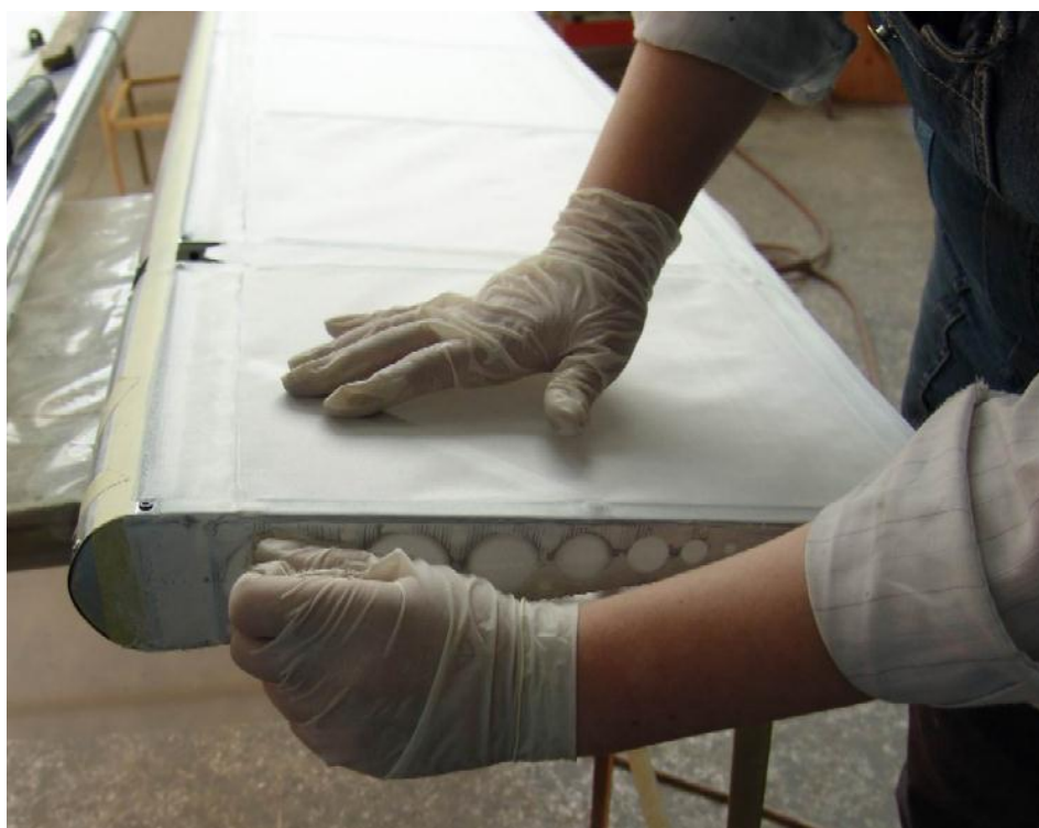
фото 34. (По корневой и концевой нервюрам ткань можно также притирать с помощью полотенца).
