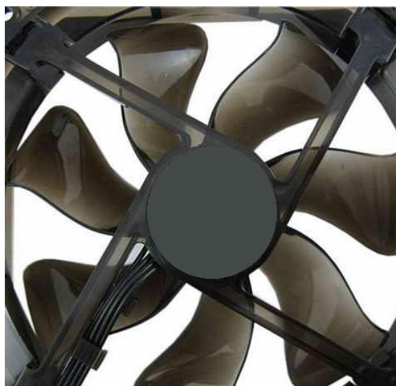
Рис.4. Вентилятор кулера центрального процессора.
