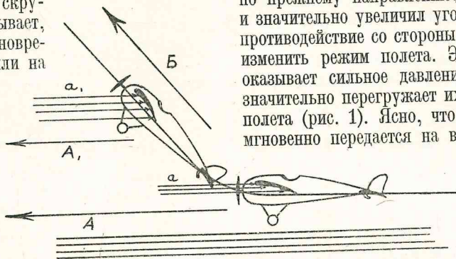
Рис. 1. Перегрузка крыльев самолета в первый момент «горки». А — горизонтальное направление полета самолета. Б — направление, по которому летчик заставляет лететь самолет, делая «горку». А 1 — направление, по которому самолет стремится двигаться по инерции в первый момент «горки». а — сопротивление встречного воздуха, которое испытывают крылья самолета в горизонтальном полете. а 1 — сопротивление встречного воздуха, которое испытывают крылья самолета в первый момент «горки».
