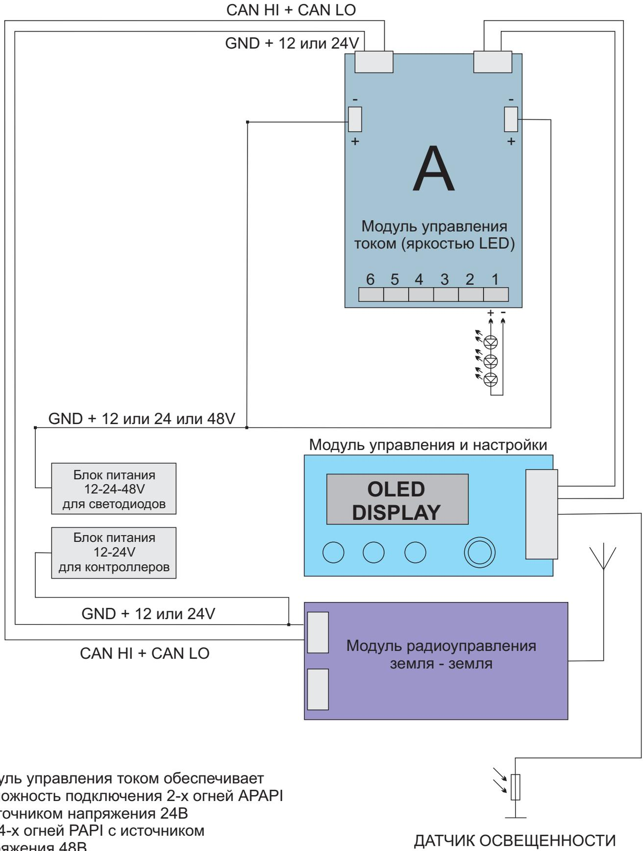
Модуль управления током обеспечивает возможность подключения 2-х огней РАРІ с источником напряжения 24В или 4-х огней РАРІ с источником напряжения 48В.
