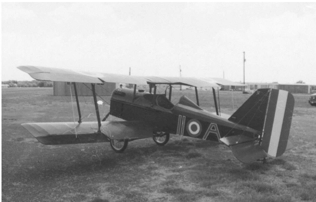
Точная копия CE-5 с трёхцилиндровым мотором Гео и редуктором Ротакс
