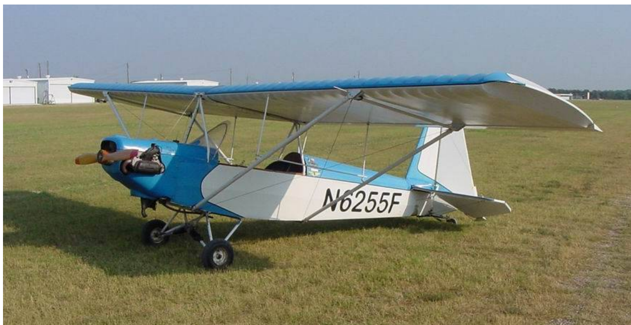
"Удачливая Леди" Дока Харра – пилотажный парасоль с мотором Фольксваген
