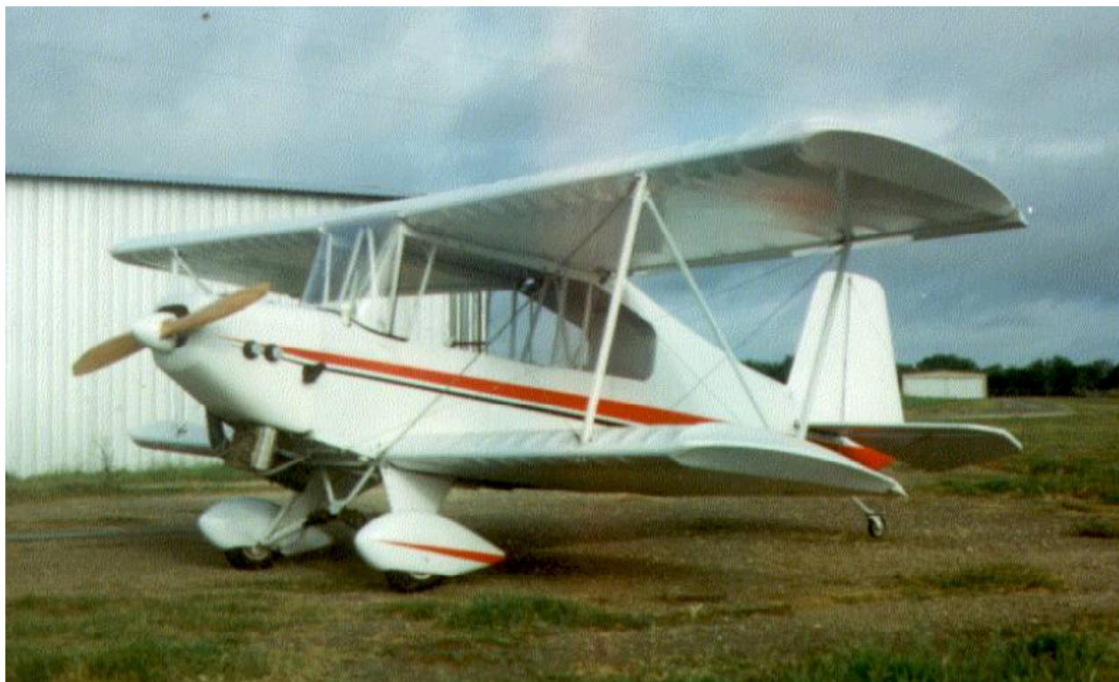
Биплан Чака Бисона с закрытой кабиной. Оснащён Ротаксом 582. Со всей этой мощностью и короткими широкими крыльями, самолёт действительно летит стремглав!
