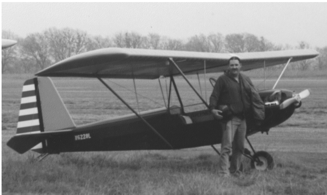
Парасоль «Арахисовое масло и Желе» Ричада Лэмба с мотором Фольксваген
