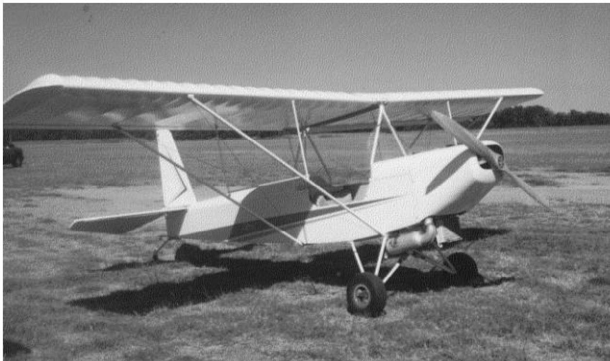
Незамысловатый сверхлегкий парасоль с двухтактным мотором водяного охлаждения.
