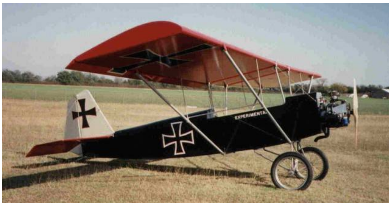
Двухместный «Дас Флюгерхунд» Сонни Мозеля с мотором Фольксваген
