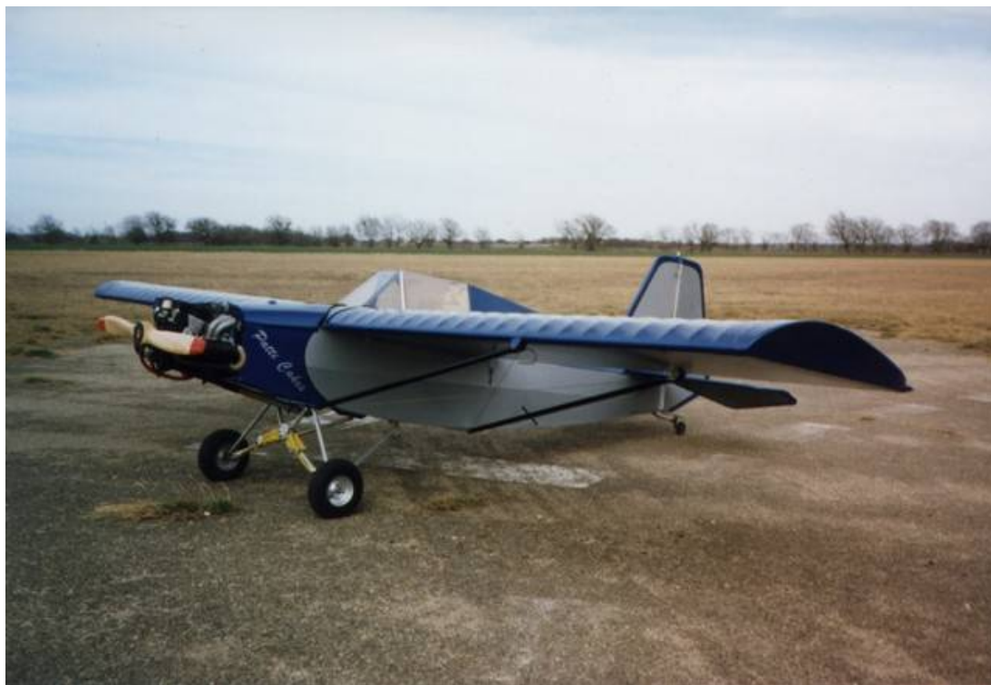
Среднеплан «Патти-Кейк» Сонни Мозеля с мотором Фольксваген.
