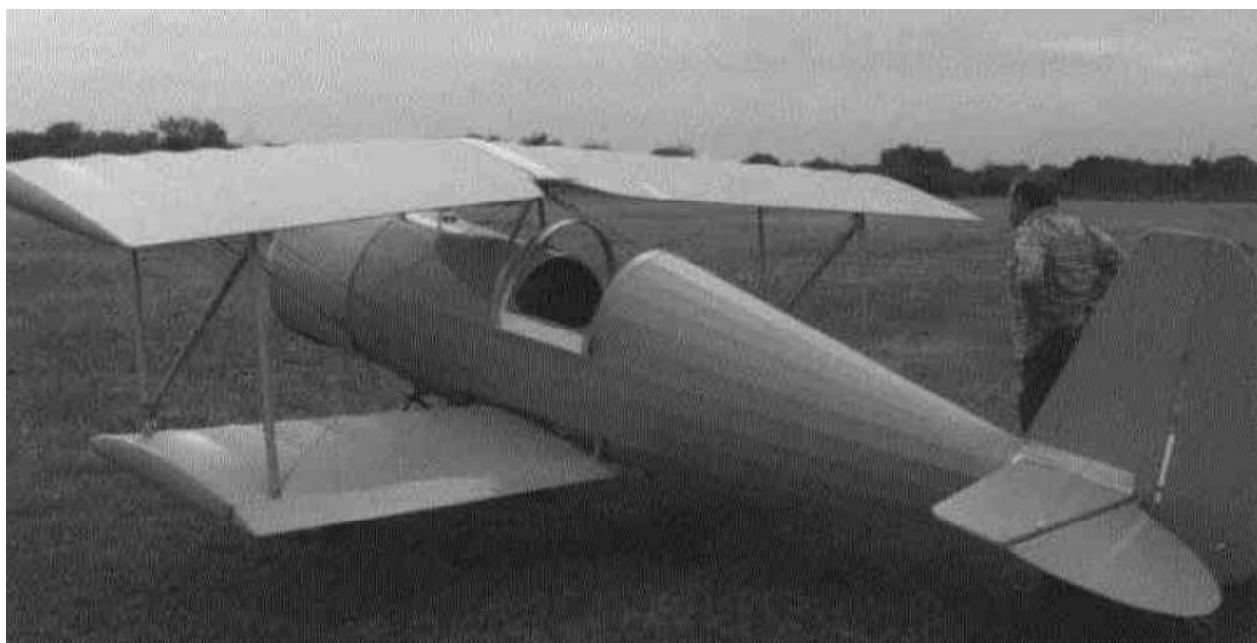
Роджер Хоппер и его ярко-желтый "Банана Байп". Обратите внимание на стреловидное верхнее крыло, А-образные стойки и полностью скруглённый фюзеляж. У него также раздвижной фонарь, аля старый Эркулес.
