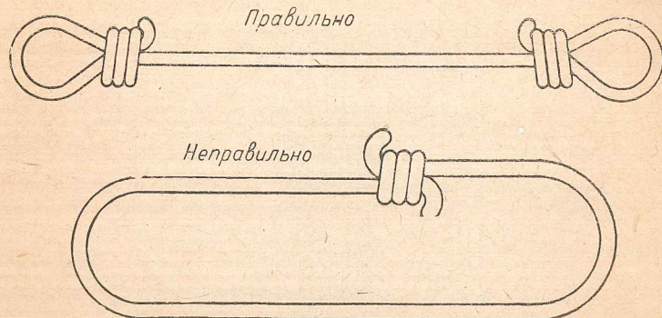
Фиг. 11. Крепление амортизационной цепи.
